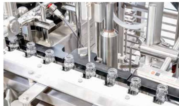
Die neue vollautomatische Vial-Füll- und Verschleißlinie mit RABS ging bei Biovian Anfang 2021 in Betrieb. Sie verarbeitet eine Reihe von Vial-Größen bis zu einer Batch-Größe von 10.000. <
