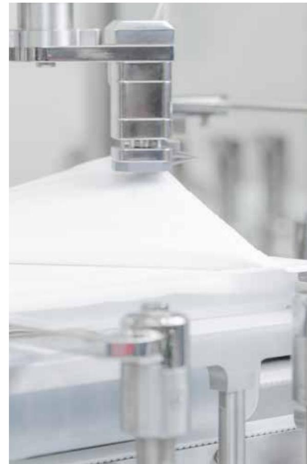
Das Abziehen der aufgesiegelten Folie des Tubs sowie das Entfernen der Tyvek-Abdeckung geschieht vollautomatisch.
