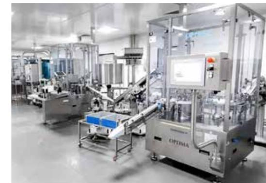
Als Standard-Dosiersystem verwendet USV in der OPTIMA SV125 Rotationskolbenpumpen. Darüber hinaus kann USV jederzeit auf ein fünfstelliges Peristaltikpumpensystem zurückgreifen.
