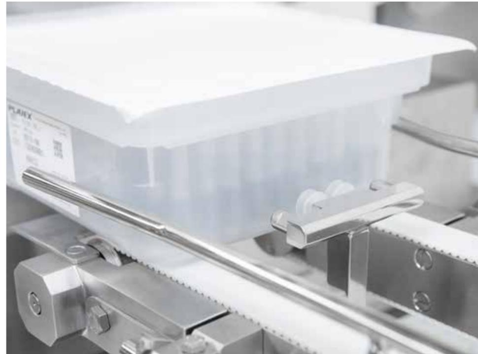
Gleich wird ein OPTIMA TRR Tyvek-Removal-Roboter die Schutzfolie abziehen.
