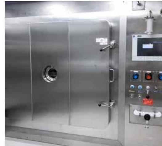
Zu sehen ist die Gefriertrocknerkammer mit Tür. Bachem setzt jetzt erstmals Gefriertrocknungsanlagen von Optima ein.
