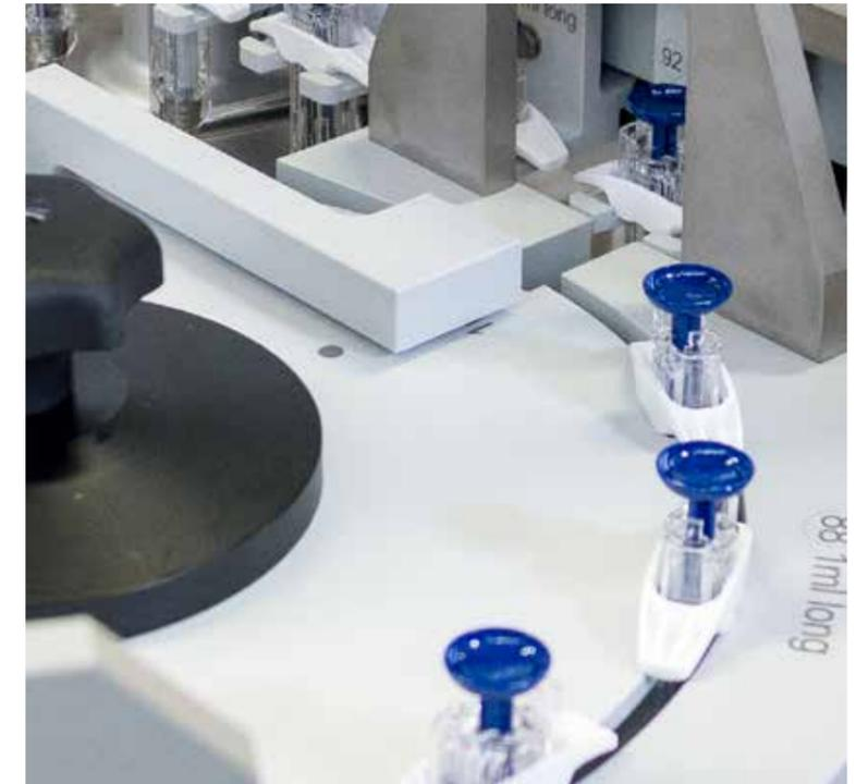
Eine zweite Optima Anlage bei USV India montiert Safety Devices. Zudem werden die Spritzen etikettiert.
