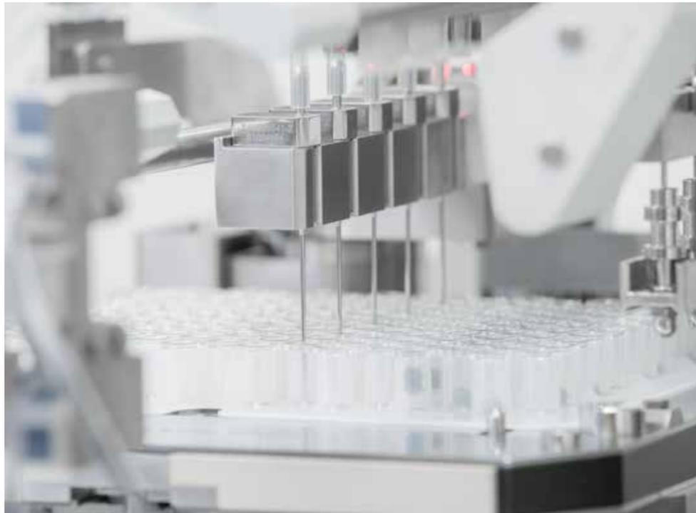
Flexible Füllprozesse für Fertigspritzen und Vials. Die Zahl der Füllstellen lässt sich zudem je nach Batchgröße anpassen.
