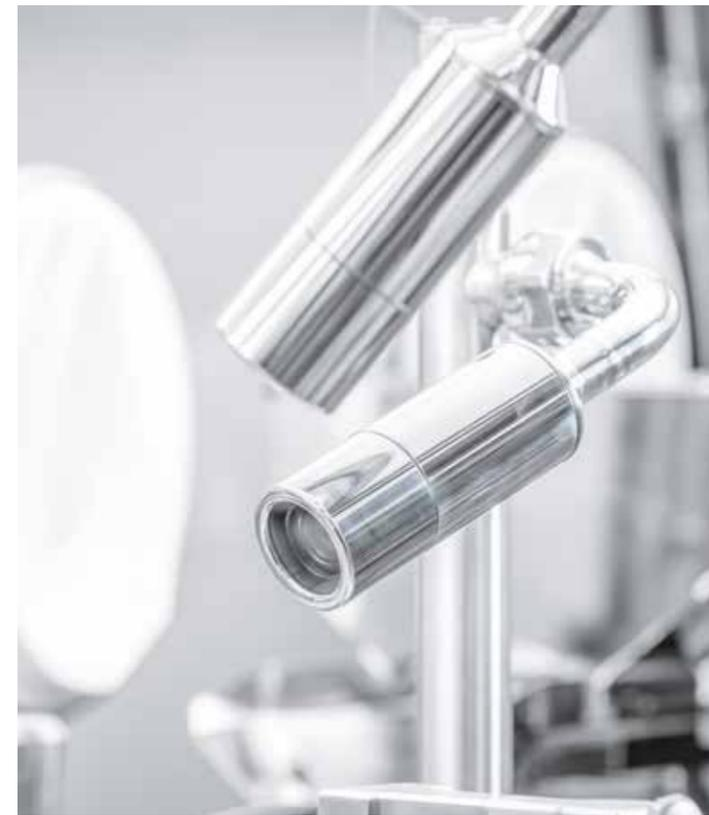
Das Video Monitoring ermöglicht die kontinuierliche Aufzeichnung des Füllprozesses und speichert Filmsequenzen im Alarmfall.
