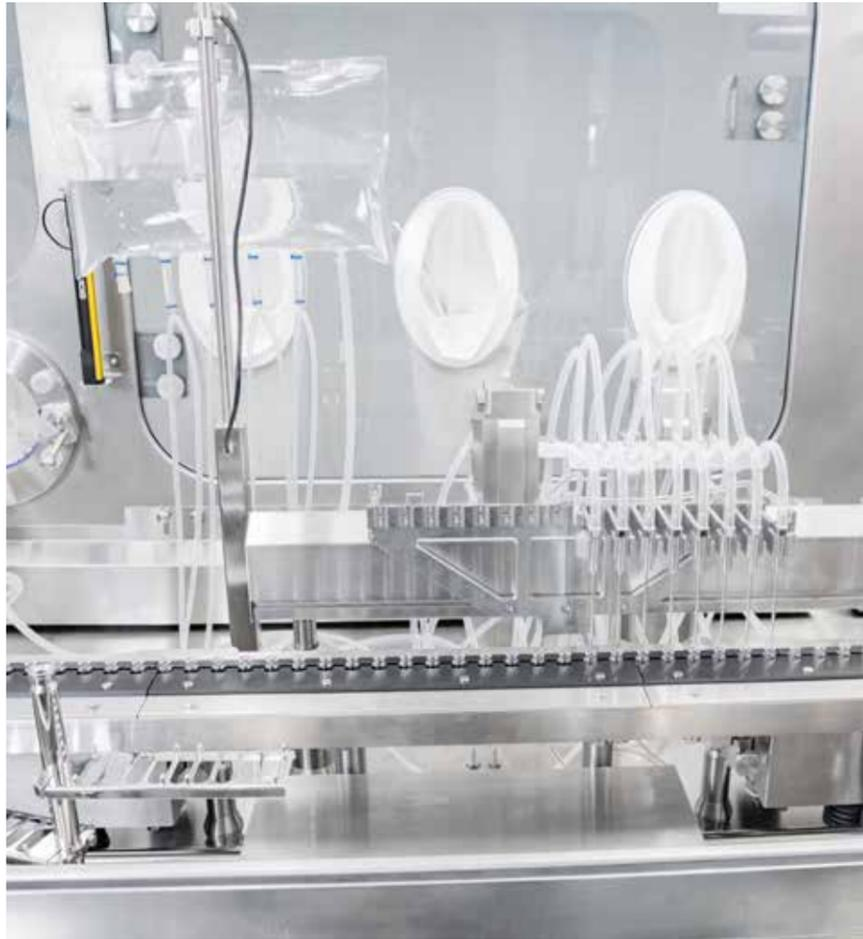
⬆️ Hochgeschwindigkeit und Präzision beim Abfüllen: Bis zu 24.000 Impfstoff-Vials verlassen die Anlage pro Stunde. Eine In-Prozess-Kontrolle prüft 100 Prozent der Behältnisse.
