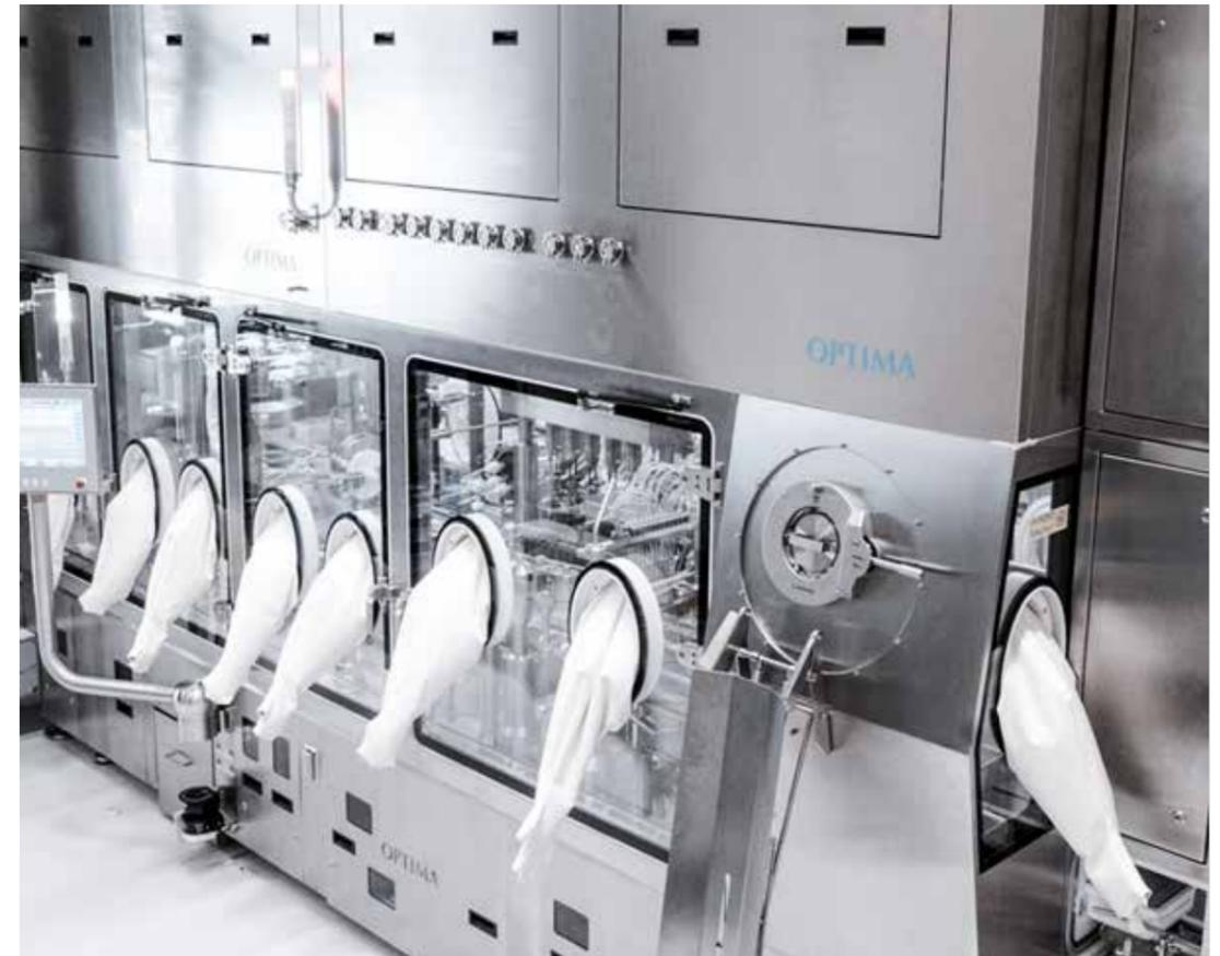
Fotografien von Isolatoren in Reinräumen können nur einen Teil der gesamten komplexen Isolorteknik zeigen. Gewissermaßen unsichtbar befindet sich über dem Isolator im Technikgeschoss die HVAC-Einheit (HVAC: Heating, Ventilation and Air Conditioning). Könnte man auf die große HVAC-Einheit und die umfangreichen Verrohrungen verzichten, ließe sich der Aufwand im Isolatorbau sowie der Aufwand für die Installation und Inbetriebnahme erheblich reduzieren.
