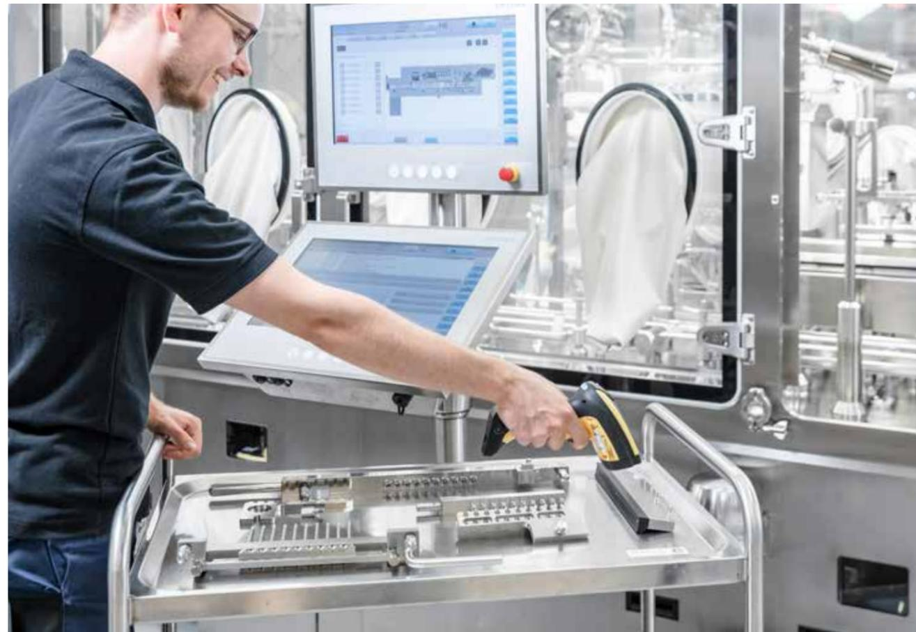
Ein weiterer Zusatznutzen des Video Monitoring: Bediener haben einen besseren Überblick über die Anlage, da die Kameras Livebilder zum HMI übertragen.
